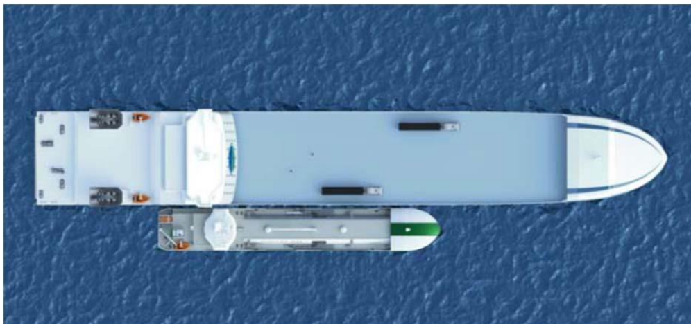
Kuva 5. Tavanomainen alusten kiinnitystapa LNG-bunkrauksessa (Swedish Marine Technology Forum).
