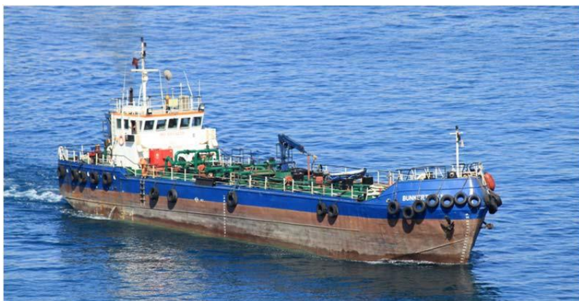
Kuva 6. Tyypillinen bunkrausalus, pituus 48 m, leveys 8 m syväys 4,3 m. 576 GT: (Kuva: Brian Crocker 2012, http://www.shipspotting.com/gallery/photo.php?lid=1560381 )
