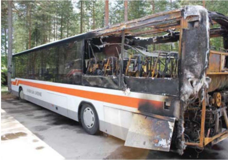
Kuva. Palo vaurioitti linja-auton takaosaa pahoin.
