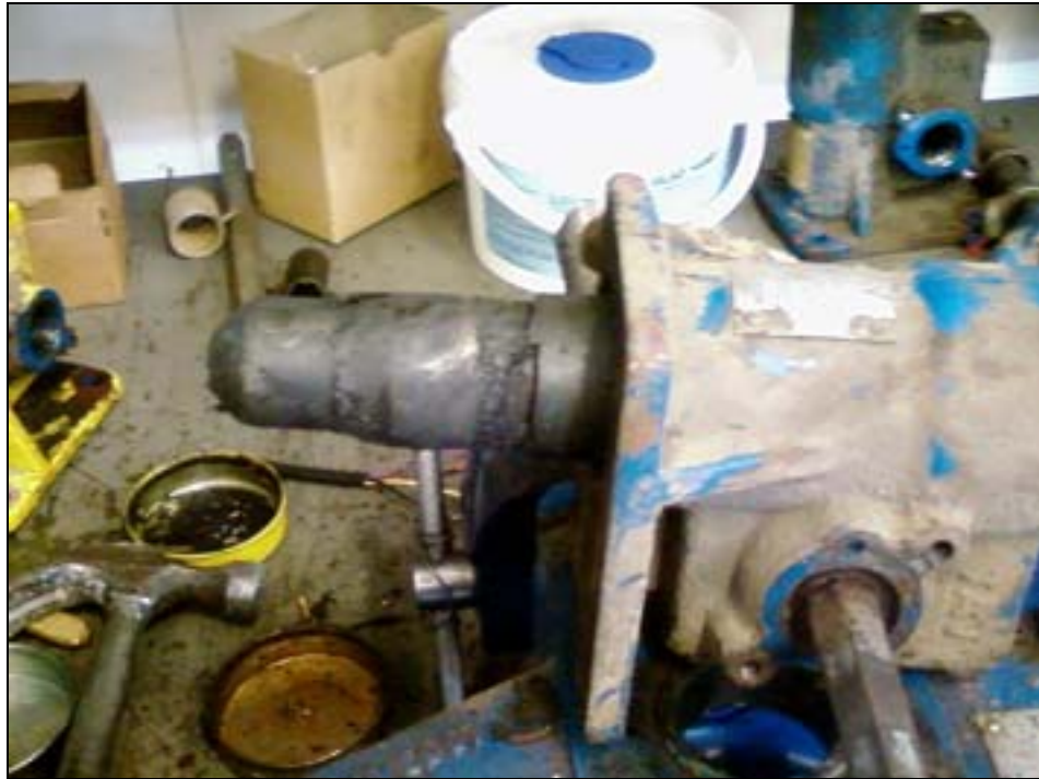
Kuva 17: Huoltamattoman vetokytkimen kulunut vetotappi
