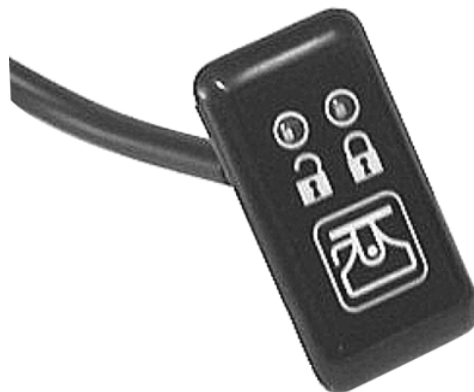
Kuva 7: Ohjaamoon asennettava merkkivalopaneeli, VBG
