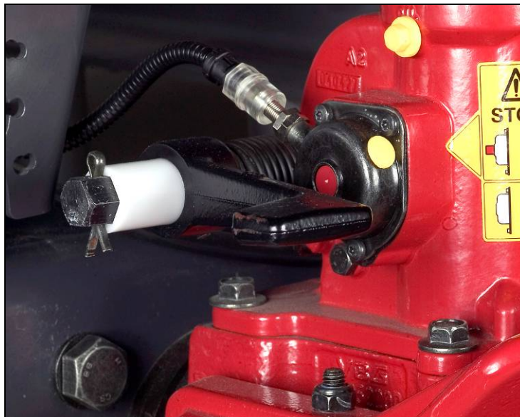
Kuva 8: Merkkivalon anturi vetokytkimessä, VBG
