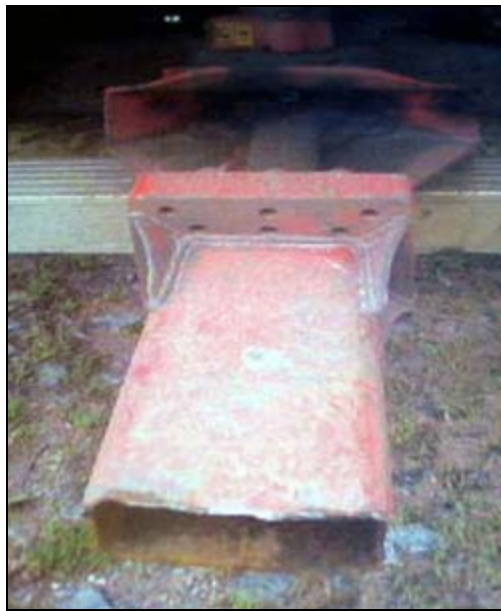
Kuva 13: Apuvaunun katkennut vetoaisa
