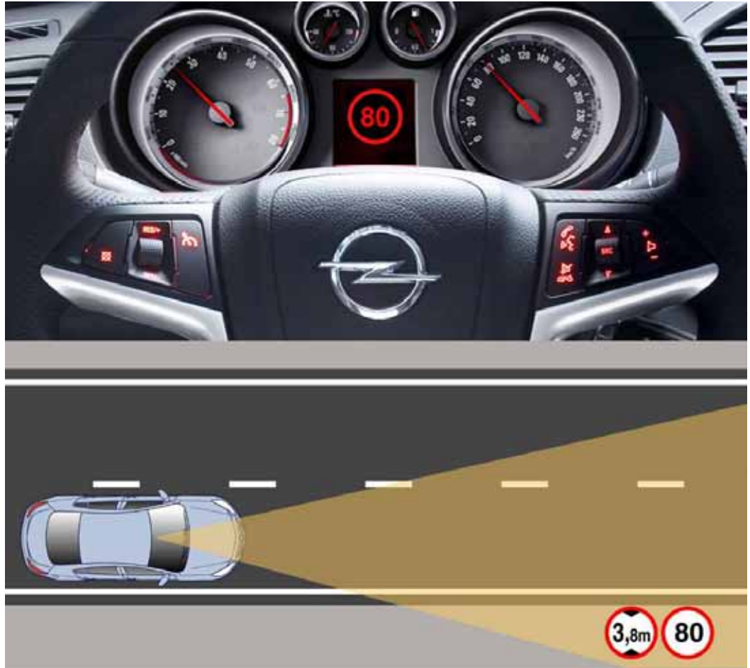
Kuva 3.32: Opel Eye tarkkailee nopeusrajoitus- ja ohituskieltomerkkejä sekä kaistalta ajautumista. Lähde: Opel.
