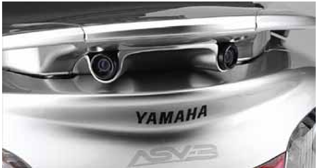
Kuva 3.49: Yamaha ASV-3 takanäkymää kuvaavat kamerat. Lähde: Yamaha Motor Company.
