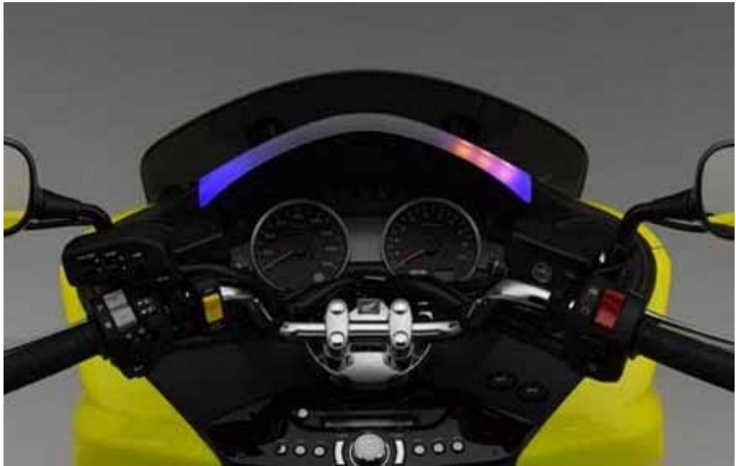
Kuva 3.41 Honda Forza ASV-4-mallin kuljettajan varoitus lähestyvistä vaaratilanteista. Lähde: Honda Corporation.
