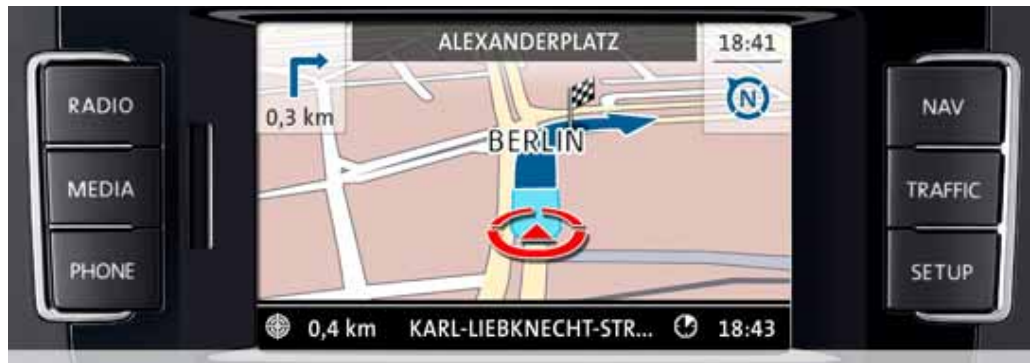
Kuva 3.52: Bosch -monimedialaitteella voidaan käyttää radiota, matkapuhelinta ja navigointia sekä näyttää liikennetietoa. Lähde: Bosch.
