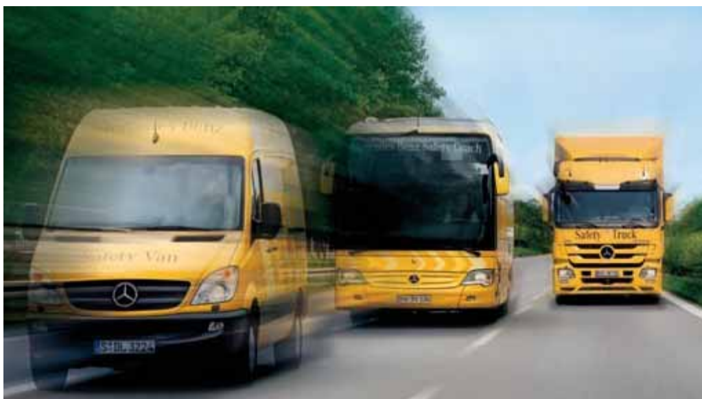
Kuva 3.34 Mercedes-Benzin "Safe Drive" tutkimusajoneuvoja, joilla on testattu mm. kaistavahtia, mukautuvaa vakionopeussäädintä ja ajovakautusjärjestelmiä. Lähde: Daimler AG.
