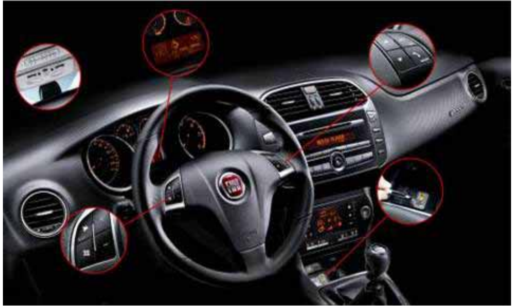
Kuva 3.31: Fiatin Blue&Me-järjestelmän käyttöliittymät: näytössä piktogrammit ja ohjauspyörässä käyttöpainikkeet. Lähde: Fiat.
