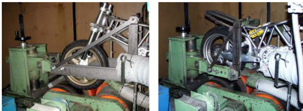
Kuva 12. Ducatin testipenkki moottoripyörän etu- ja takaosalle (Di Piazza 2003, 7).
