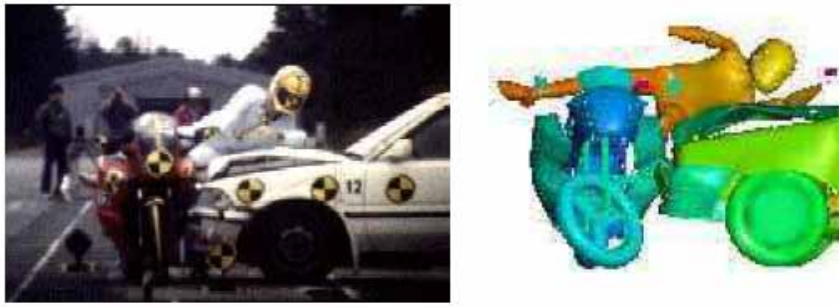
Kuva 2. FE-menetelmällä simuloitu moottoripyörän ja auton törmäys (Chawla ym. 2003, 5).
