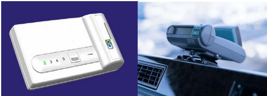
Kuva 3. Vasemmalla Itävallan tiemaksujärjestelmän mikroaaltotunniste (DSRC) ja oikealla Saksan satelliittiperusteinen tiemaksulaite.
