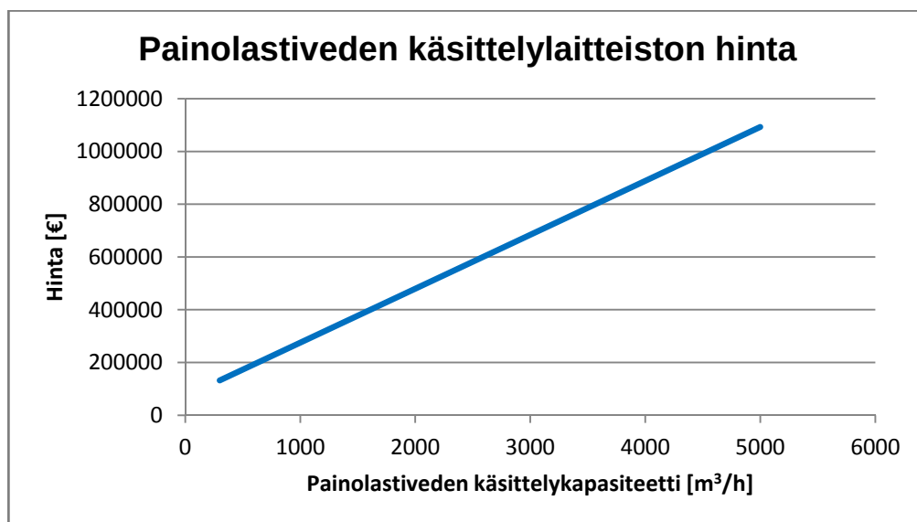
Kuva 6. Painolastiveden käsittelylaitteiston laitehintaa käsittelykapasiteetin funktiona.
