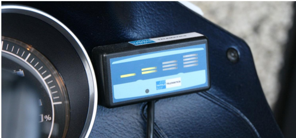
Kuva 4. Ajotavan seurantalaitteen näytössä on neljä valopilaria, joissa voi palaa vihreä tai punainen valo. Kuva: Ramboll
