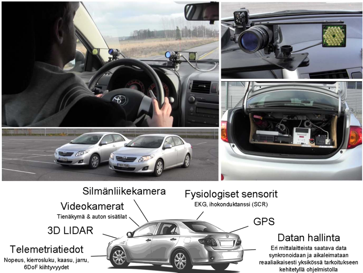
Kuva 1. Ajokoulutuksessa käytetty tutkimusauto. Silmänliikemittaus tapahtuu kiinteisiin kameroihin perustuvalla SmartEyePro-järjestelmällä, jolloin silmänliikkeet voidaan kuvata auton koordinaatistossa. Data-analyysit tehdään yksikön omilla signaalinkäsittelyalgoritmeilla.
