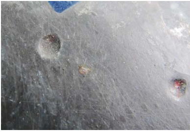
Nastan jälkiä lyijylevyn pinnalla
