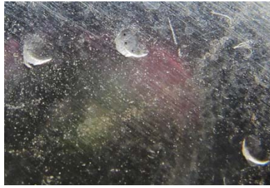
Nastan jälkiä alumiinilevyn pinnalla
