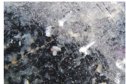
Nastan jälkiä kivilevyn pinnalla
