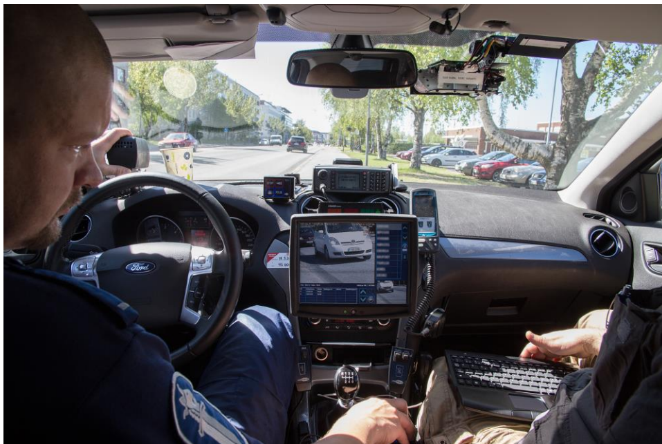
Kuva 1. Poliisiautoon asennettu Revika-laite, kuljettajan paikalla vanhempi kons-taapeli Timo Vihervaara (kuva: Sari Karhu).
