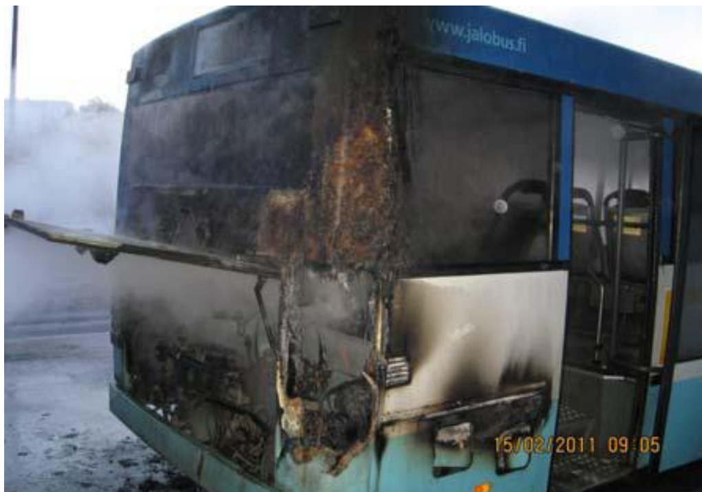
Kuva 2. Palo sai alkunsa moottoritilassa laturista.
