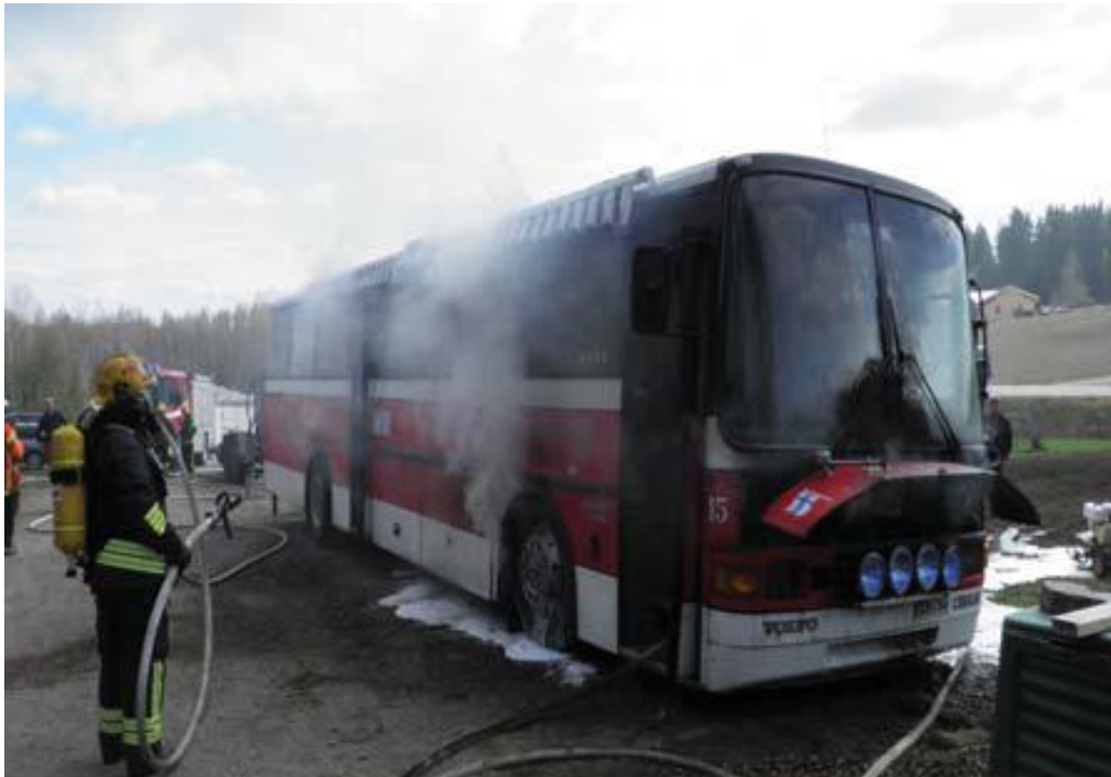
Kuva 16. Palo eteni pyöräkotelon puolelle.
