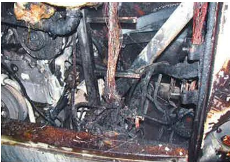
Kuva 26. Palo syttyi linja-auton moottoritilassa.
