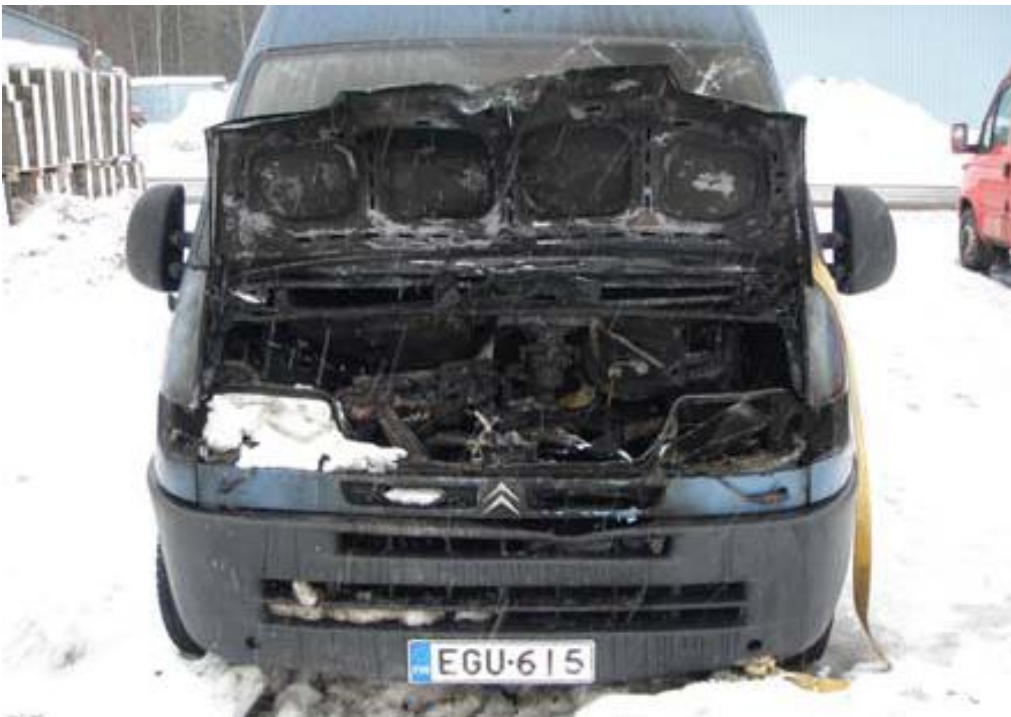
Kuva 4. Tulipalo syttyi minibussin moottoritilassa.
