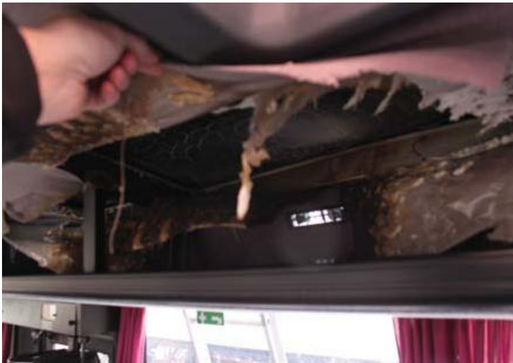
Kuva 11. Palo levisi linja-auton sisätiloihin tuhoten verhoilua.
