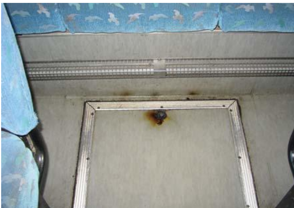
Kuva 14. Alkusammutuksella tulipalo saatiin rajattua moottoritilaan, palo ei päässyt leviämään matkustamon puolelle.
