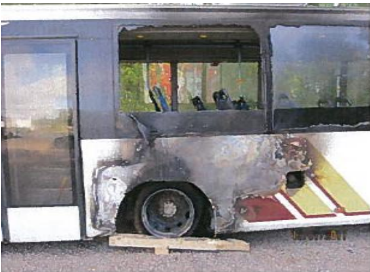
Kuva 18. Linja-auton takarengas syttyi tuleen ja palo levisi matkustamoon.
