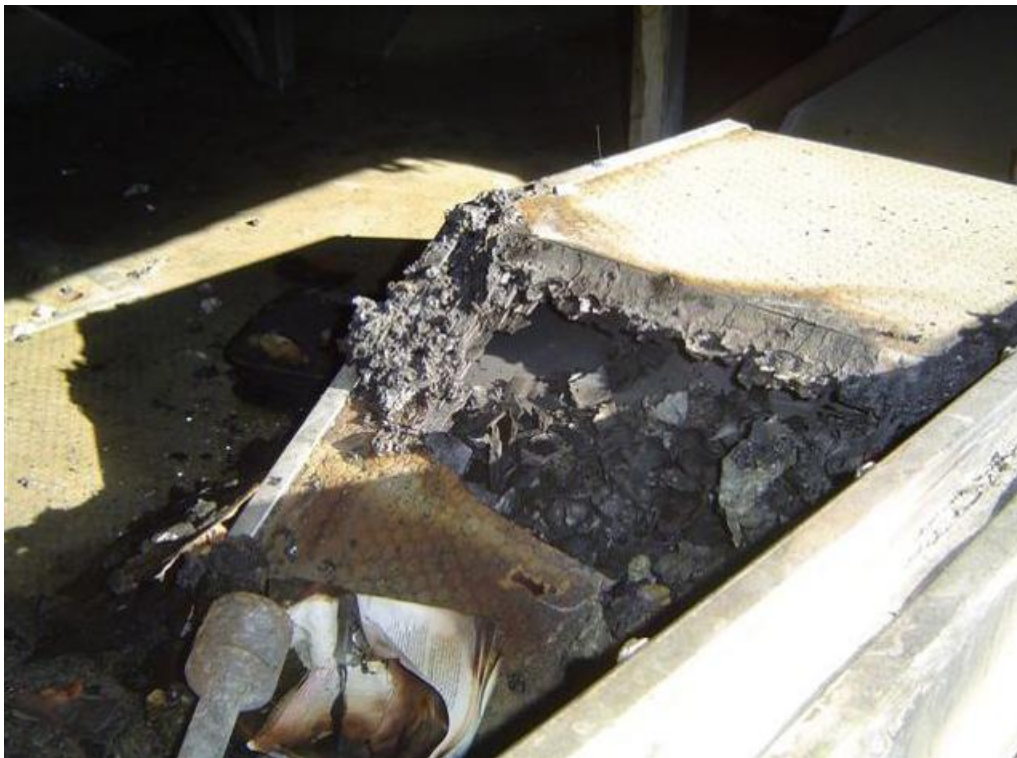
Kuva 6. Palo eteni rengaskotelon yläpuolella olevaan tavaratilaan.
