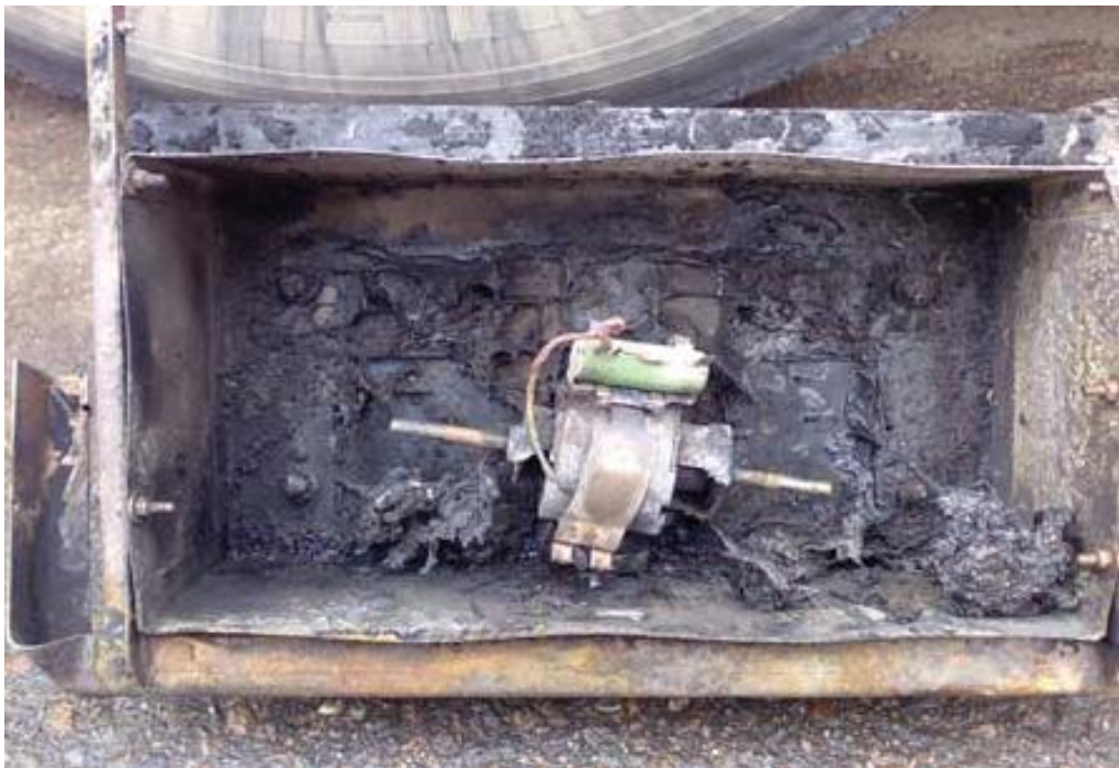
Kuva 10. Palo sai alkunsa linja-auton katolla olleesta raitisilmapuhaltimesta. Kuvassa puhallin irrotettuna.
