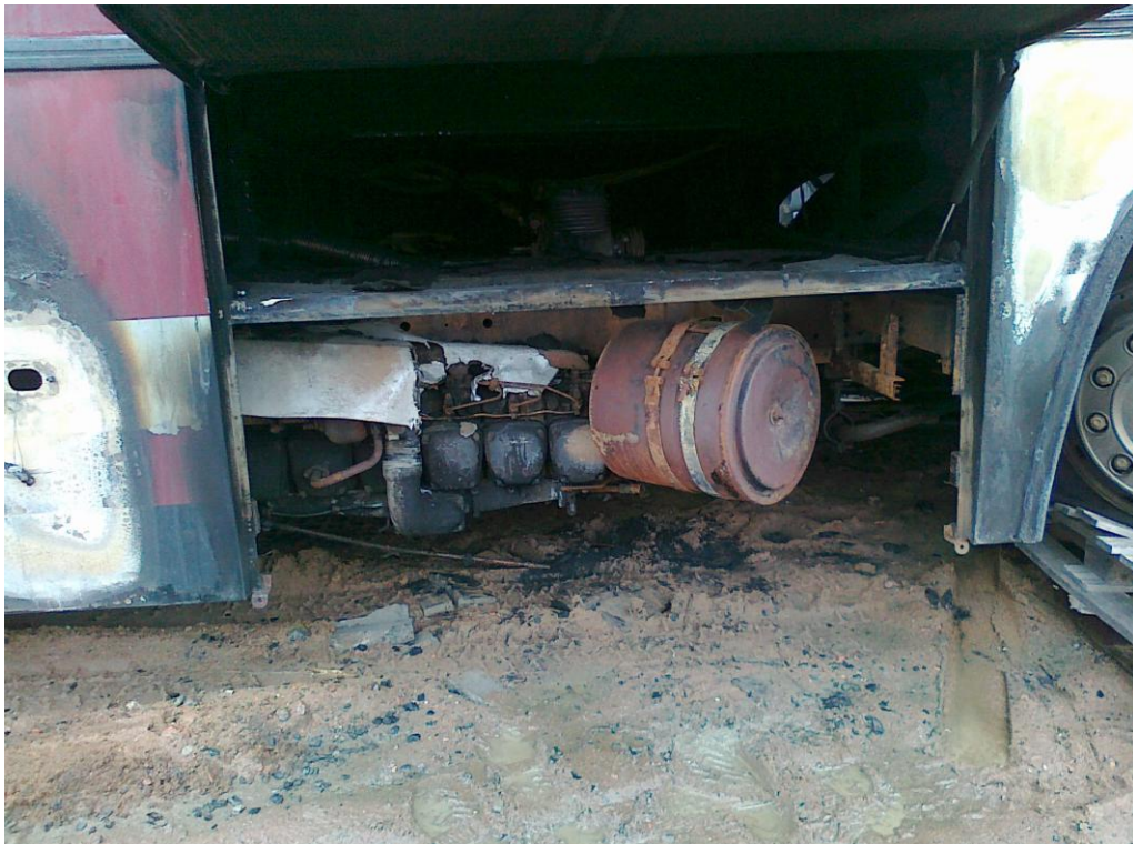
Kuva 8. Palo rajoittui linja-auton keskellä olevaan moottoritilaan ja sen yhteydessä oleviin säilytystiloihin.
