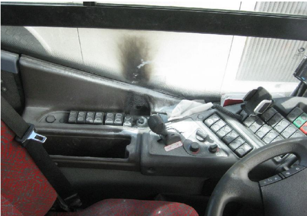
Kuva 9. Peilien sähköinen säätökytkin ylikuumentui ja sytytti muoviosia palamaan.
