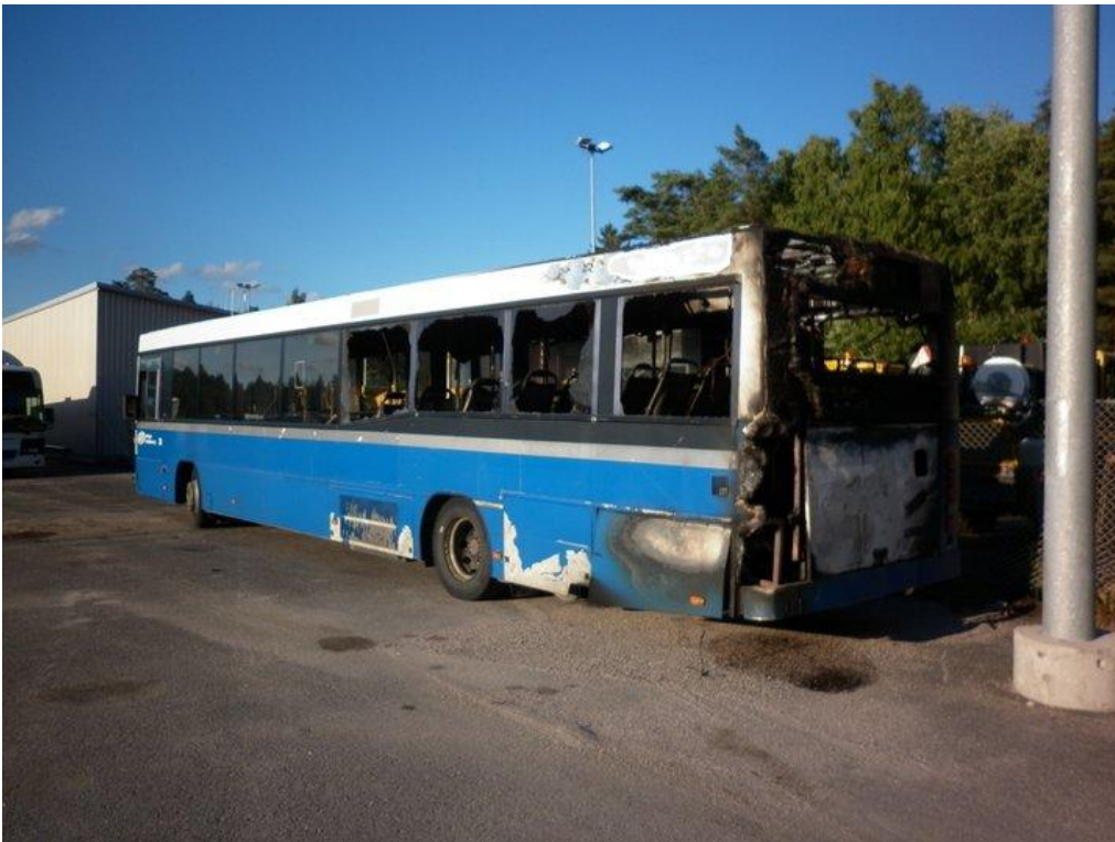
Kuva 20. Palo syttyi linja-auton moottoritilassa.
