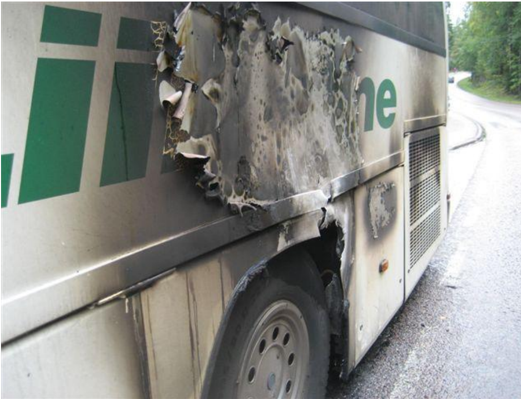
Kuva 23. Palon eteneminen linja-auton sisätiloihin saatiin estettyä.
