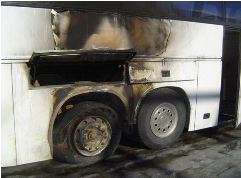
Kuva 5. Linja-auton oikean telipyörän taaempi rengas syttyi palamaan.
