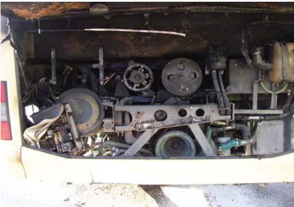
Kuva 12. Palo syntyi linja-auton moottoritilassa.
