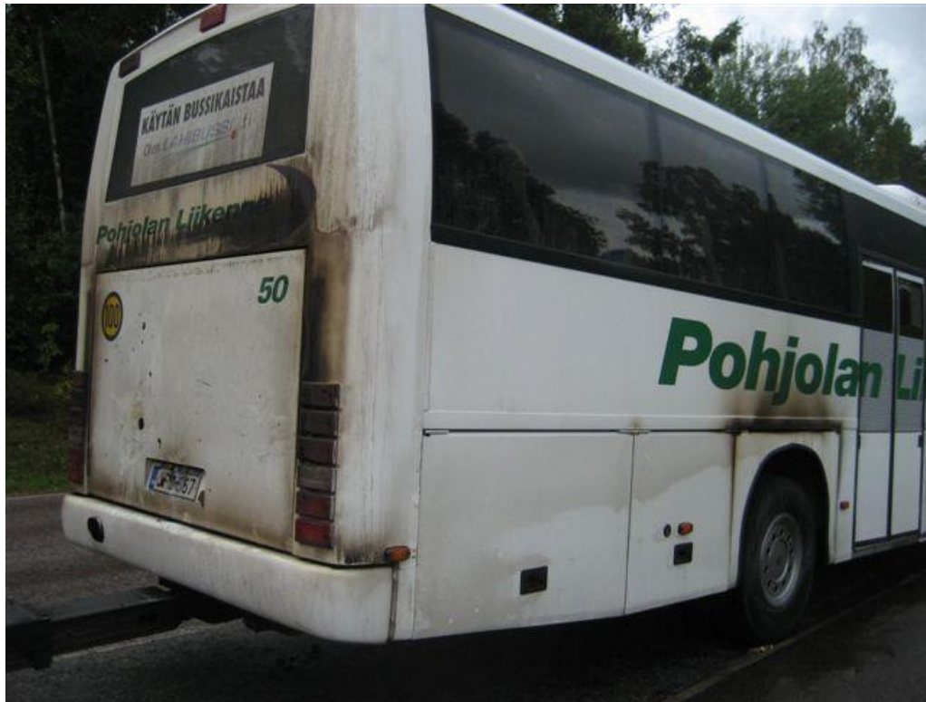
Kuva 22. Palo syttyi linja-auton moottoritilassa.
