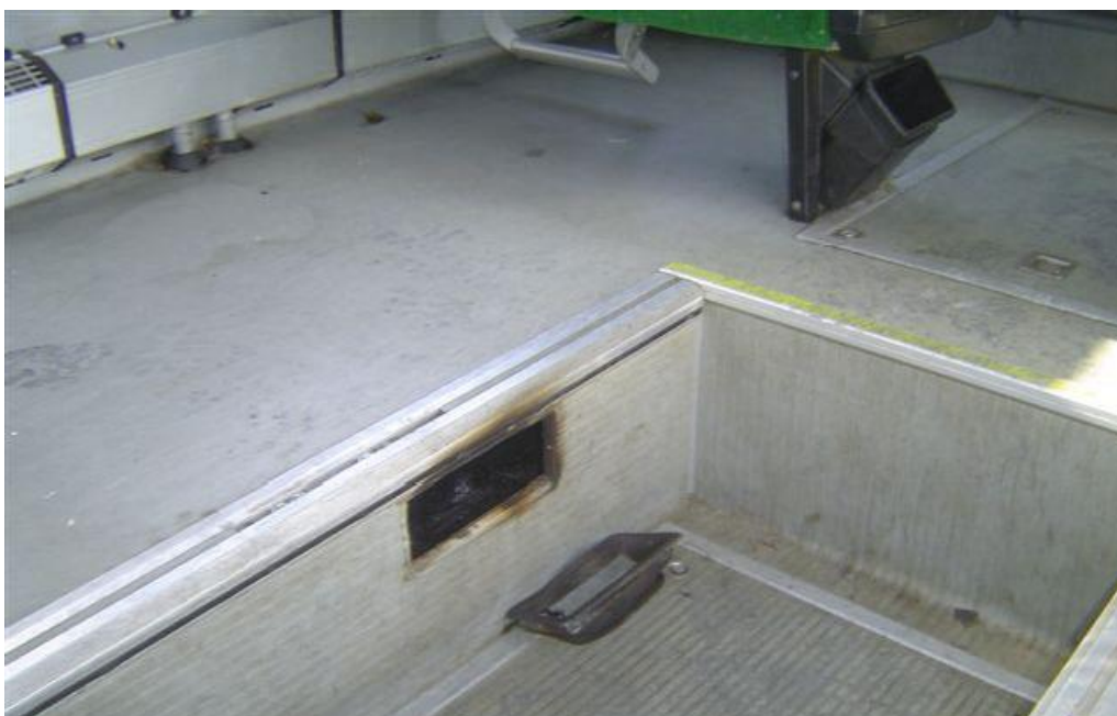
Kuva 7. Savu levisi linja-auton tavaratilasta matkustamon puolelle.
