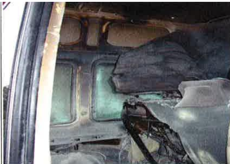
Kuva 24. Linja-auton matkustamon lämmityslaitteesta alkanut palo tuhosi linja-auton sisustusta.
