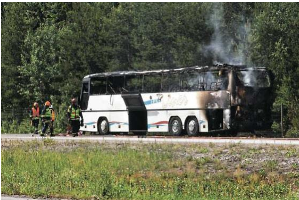
Kuva 17. Moottoritalasta alkanut palo tuhosi linja-auton käyttökelvottomaksi.
