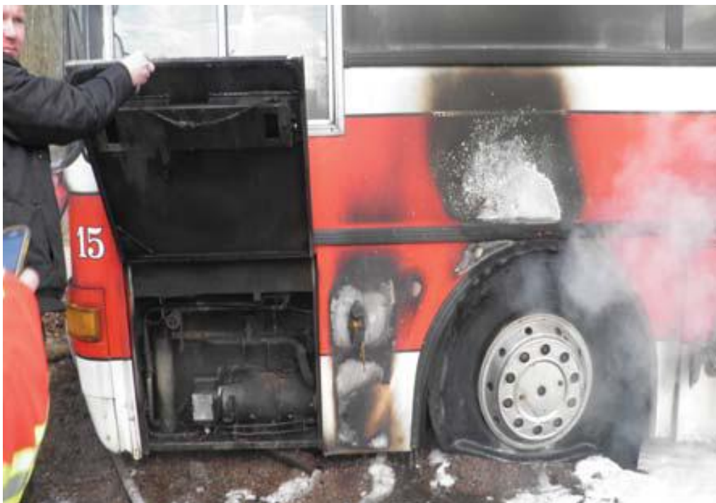
Kuva 15. Palo sai alkunsa todennäköisesti Webasto-lämmittimen käynnistyksen jälkeen.
