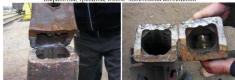
Излом хвостовика автосцепки по старой трещине
