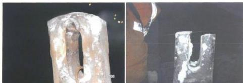
Выработка, трещина, излом хвостовика автосцепки
