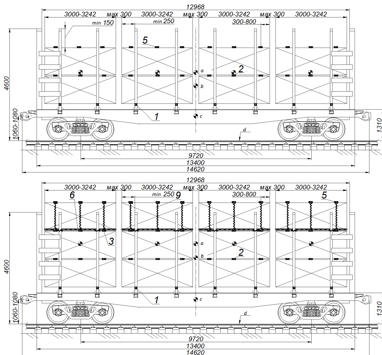
Kuva 5.4.3. Paketoidun sahatavaran kuormaaminen ja kiinnittäminen matalalaitaiseen avovaunuun, mallit 13-401-06, 13-4012-06, 13-2114-06, joissa varusteena 4443-02:
