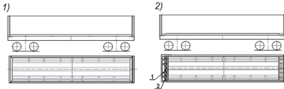
Kuva 236 - Alustojen sijoittaminen korkealaitavaunuun
