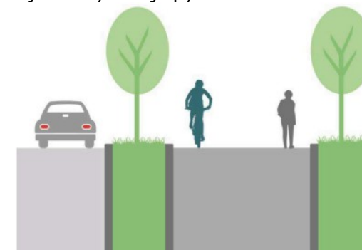
Kuva 26. Yhdistetty jalkakäytävä ja pyörätie
