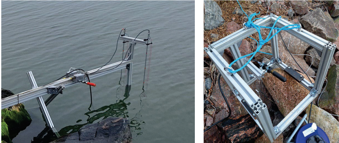
Kuva 3. Valokuvat aaltoantureista (vas.) ja pohjaan asennetusta hydrofonista (oik.).
